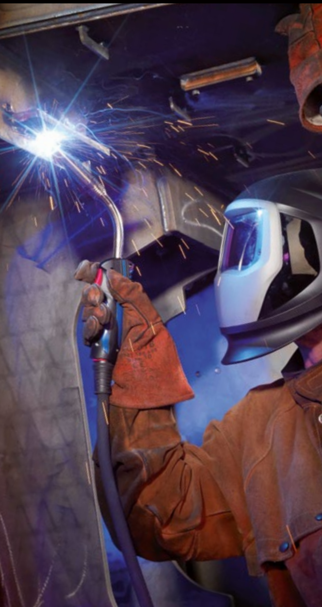
MB EVO PRO 36 metināšanas pozīcijā PA (sadaršuves un stūra šuves horizontālā metināšana)
