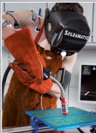
MB EVO PRO 36 metināšanas pozīcijā PA (sadaršuves un stūra šuves horizontālā metināšana)
